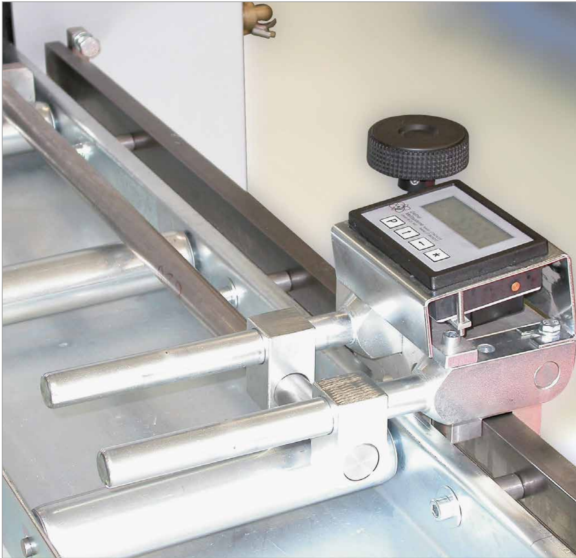
Brillant 260 / Rollengang und digitaler Messanschlag
